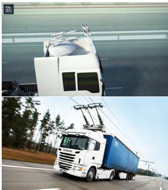
Figur 2: Grafik och bild av pantograf placerad på lastbils tak vid laddning på Siemens "eHighway". Bilder hämtad från Siemens webbplats. [5]
