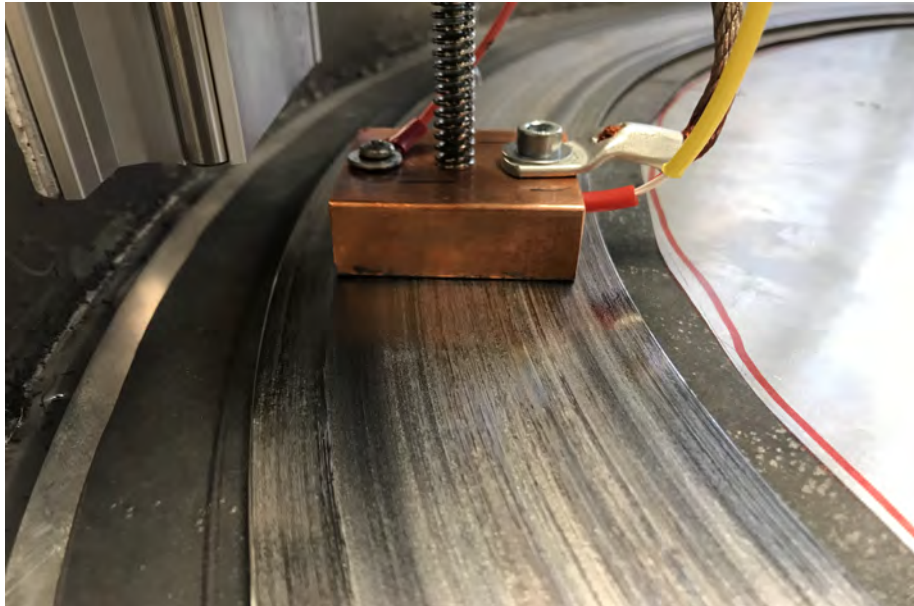
(a) Färg i kontakt som leder ström upp från bana efter körda tester.
