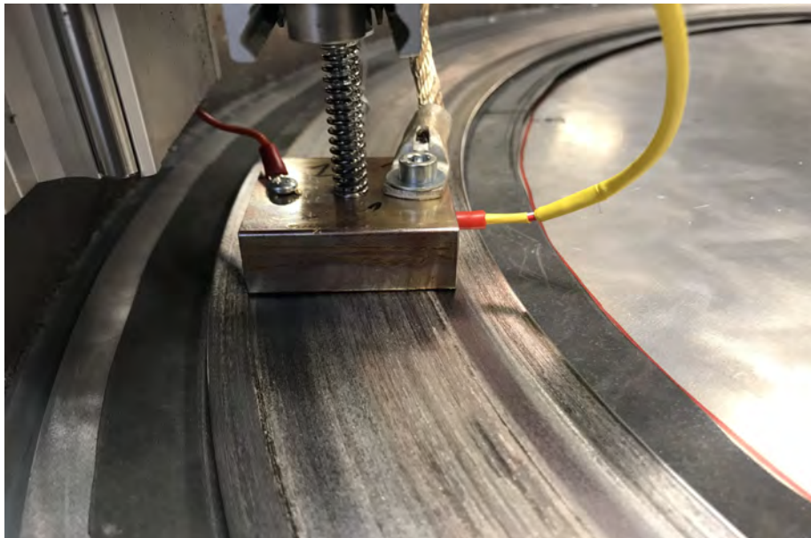
(b) Färg i kontakt som leder ström ner i bana efter körda tester.
