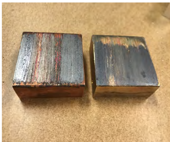
Figur 31: Visar bild på undersida av släpkontakt i koppar efter körda tester. Till vänster kontakt som leder ström upp ur bana och till höger kontakt som leder ström ner i bana.
